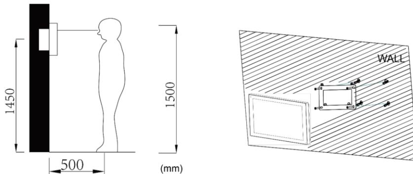
1. Определите место установки монитора. Рекомендуемая высота установки монитора: 1,5 метра. Высота установки может быть изменена по желанию пользователя.
