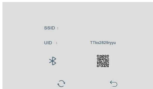
В строке SSID отображается имя домашней сети к которой подключен монитор.
